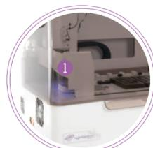
Adaptado a la tecnología DNA Flow, con capacidad para 24 muestras en el proceso de hibridación y 48 tubos de PCR en el proceso de amplificación.
