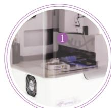
Con capacidad para 12 muestras en el proceso de hibridación y 24 tubos de PCR en el proceso de amplificación.
